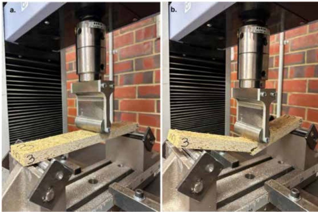
Рис. 2. Міцність на згин зразків ізоляційних матеріалів на основі конопель: (а) випробувальна установка, (б) після випробування
